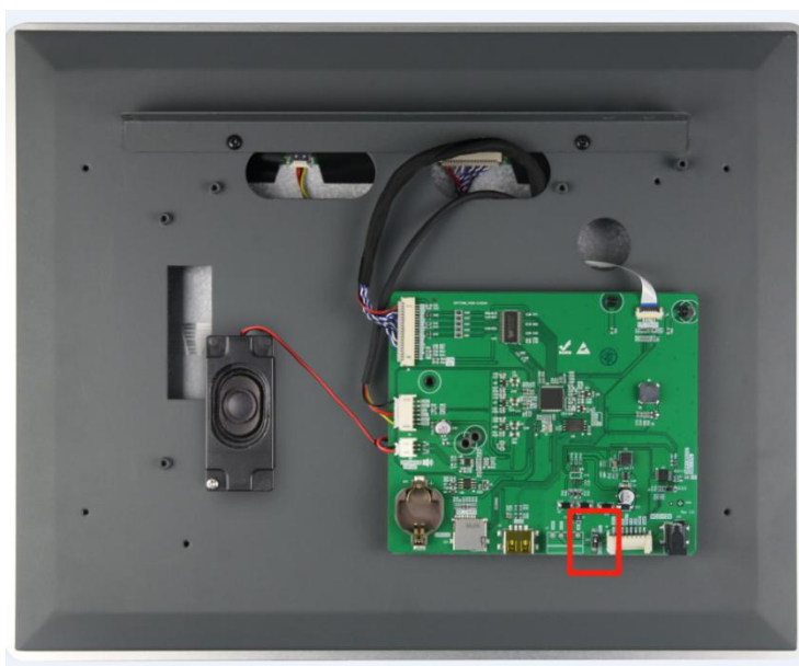
图 8-2 电平转换开关位
